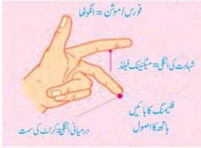
شکل 17.6: میگنٹک فیلڈ میں پڑے کرنٹ لے جانے والے کنڈکٹر پر لگنے والی فورس کی سمت
