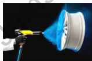
Fig: 14.14 Spray paint
